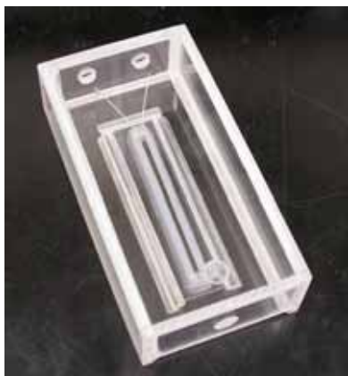
図2 . 電気融合用チャンバーを斜め上から見たところ . 中央の溝が白金電極間のスペースでここに細胞を入れる。上部に接続用の白金線が 2 本見える。ここに電極線をつなぎ電流を流す。
